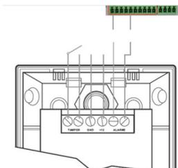
Na configuração da entrada de alarme do DVR, se o tipo de contato for normalmente aberto (NO), o alarme será ativado quando o contato estiver fechado.
