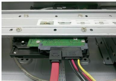
6. Conecte uma extremidade do cabo de transmissão de dados a placa;
