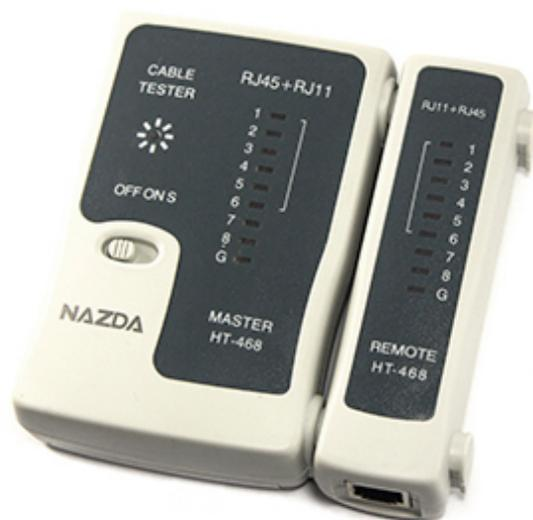
O testador de cabo NZ-468 da Nazda é uma ferramenta utilizada para verificar a continuidade e a correta conexão de cabos de rede RJ11 e RJ45.
