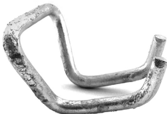
O Anel guia é utilizado para sustentação e ancoragem de fios e cabos de telecomunicações nos postes através de fita de aço inox juntamente com o esticador de fio FE e Alça plastica para fio FE, confeccionado em arame galvanizado a fogo.
