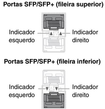
Os indicadores mostram o status do link e a velocidade de conexão da porta LAN ou SFP/ SFP+.
