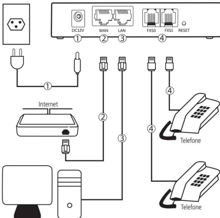
1. Conecte a fonte de alimentação na entrada DC 12 V. Os LEDs e SYS acenderão. Após alguns segundos o LED SYS apagará e os LEDs centrais do ATA 200 acenderão e apagarão rapidamente informando que está ocorrendo a inicialização do sistema. Quando o LED SYS voltar a piscar lentamente, indicará que o produto está inicializado e pronto para uso;
