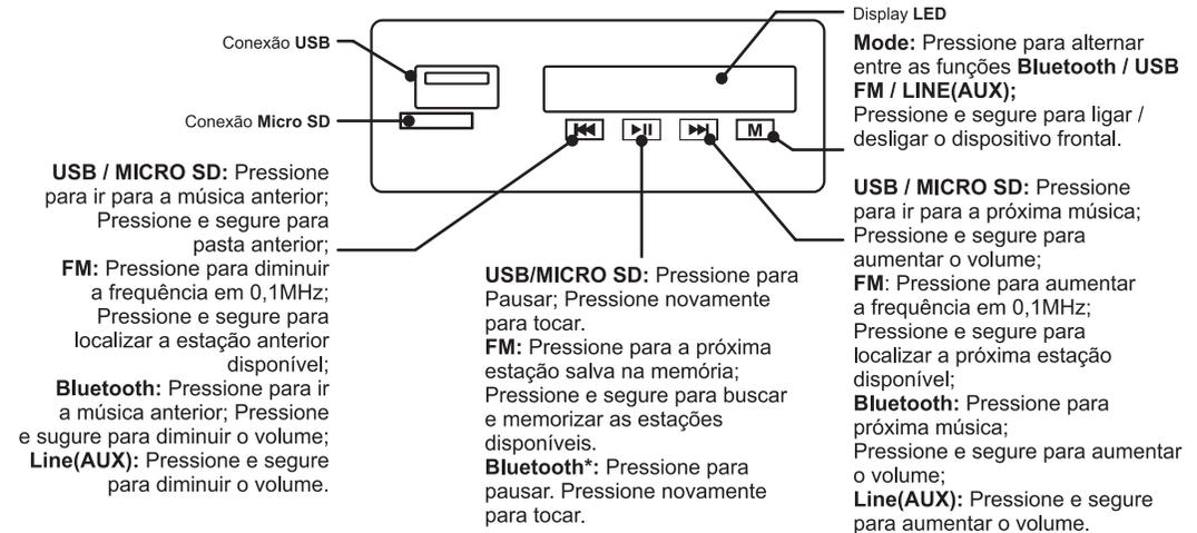
\*Bluetooth: O processo de comando do aparelho celular via conexão Bluetooth depende de pré-definições do aparelho. Verifique no manual do seu aparelho celular se ele permite esta função. **Alcance do Bluetooth:** 5 metros.
