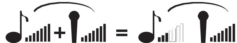
O GR 7000 BT 70V possui o recurso de Volume Inteligente, que pode ser habilitado ou desabilitado, de acordo com a aplicação do aparelho (ver no final da página como fazer esta configuração) Através de um circuito interno, o GR 7000 BT 70V reconhece o som da voz, através do canal de microfone e automaticamente diminui o som da trilha sonora de audio que está sendo reproduzida através das AUX1 / USB ou AUX2, deixando em destaque a locução do usuário.
