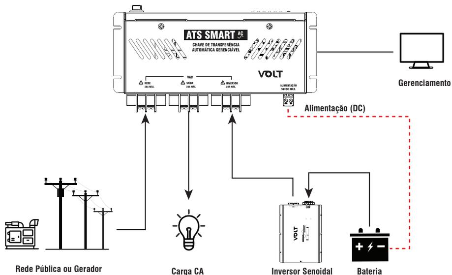
**Exemplo 4:** Rede elétrica (ou gerador) com reserva por inversor, carregador de bateria e bateria. A escolha de prioridade de entrada poderá ser selecionada na gerência da ATS SMART. Por padrão de fábrica, a prioridade é a entrada rede.
