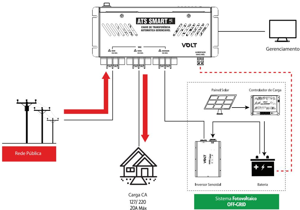
**Exemplo 2:** Prioridade de operação sistema fotovoltaico OFF-GRID com backup utilizando um a rede elétrica proveniente da concessionária de energia.
