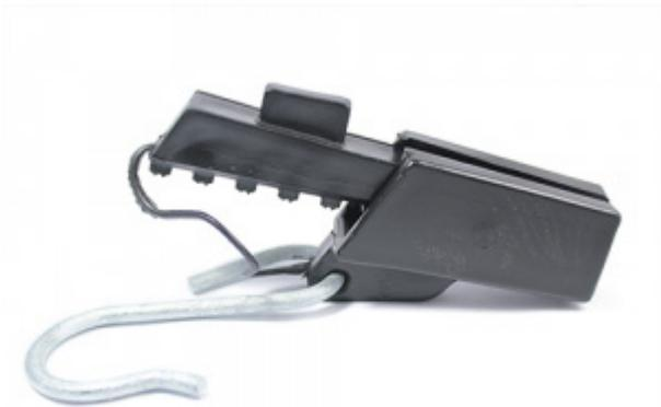
Esticador para cabo, desenvolvido para possibilitar a ancoragem de cabos em roldanas ou postes. Utiliza sistema de cunha para acentuar o travamento do cabo.
