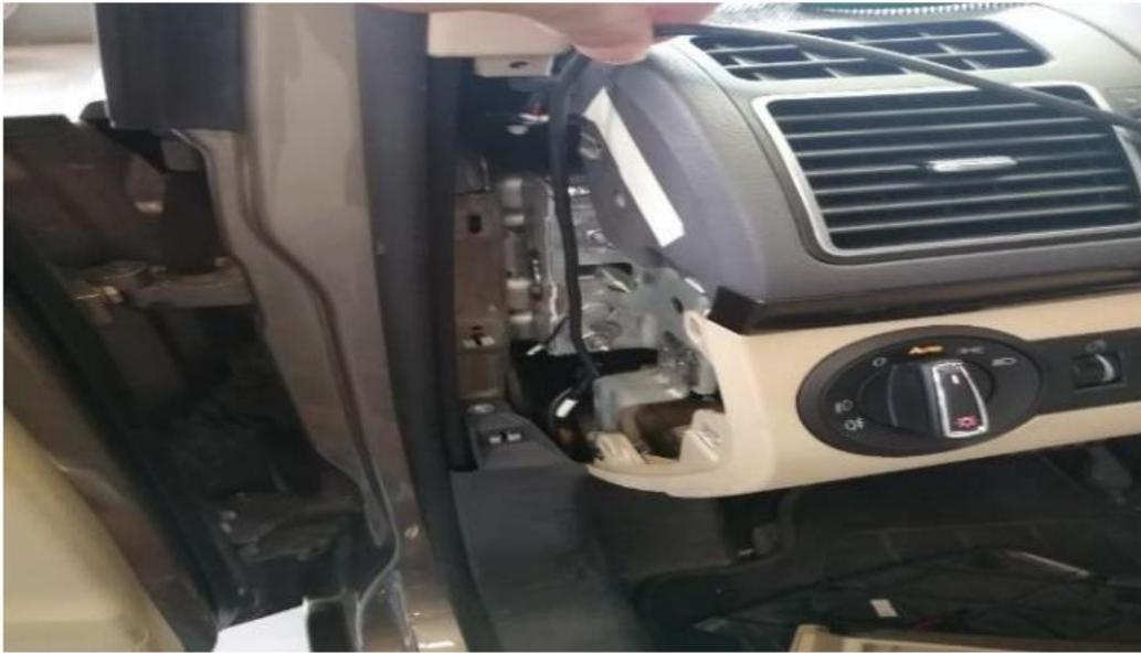
Figura 2-3 Conectando a alimentação
