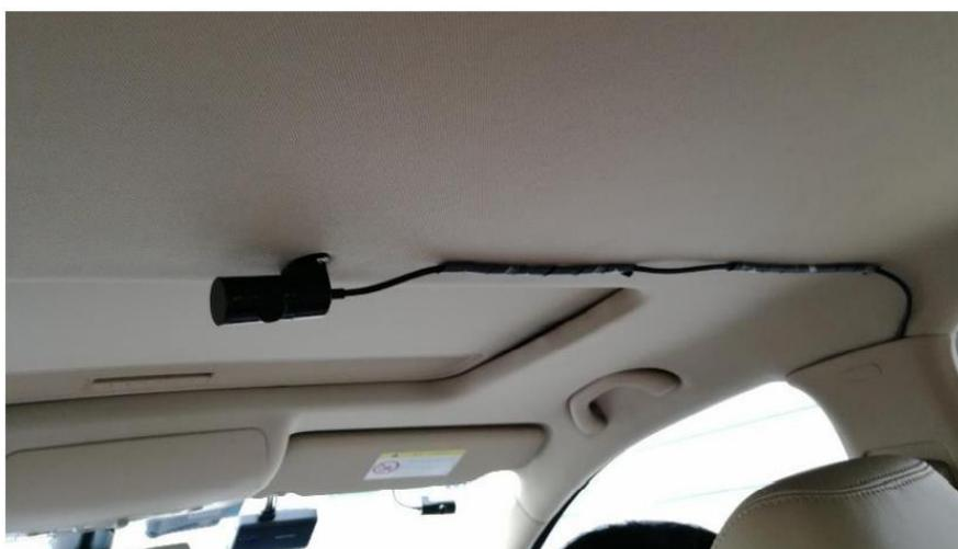
Figura 2-19 Instalação da Câmera Traseira
