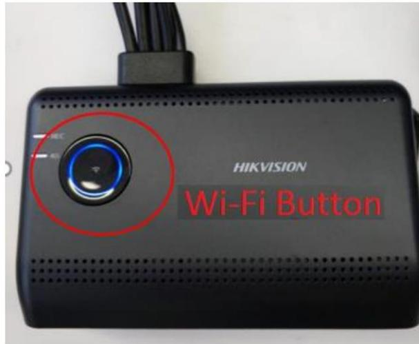
Figura 2-6 Pressione o botão Wi-Fi no dispositivo
