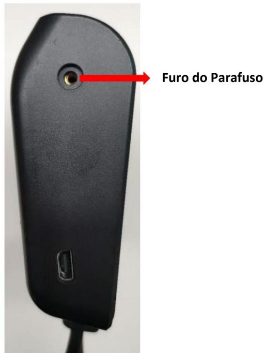
Figura 2-12 Fixação da Lente da Câmera
