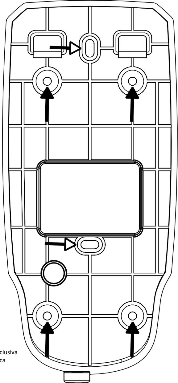
➔ Furos para fixação na parede
