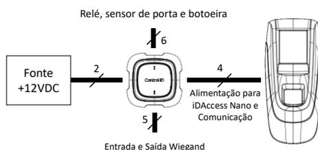
1. Para maior segurança na instalação, colocar o Módulo de Acionamento Externo (MAE) em uma região segura (parte interna da instalação).
