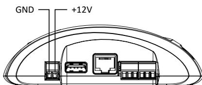
⚠ A alimentação da iDBox será fornecida pela fonte 12V/1A, através do conector de alimentação ao lado (GND / +12V).
