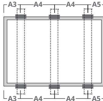
Utilize seis grampos no lado longo. Os trilhos de montagem são perpendiculares à estrutura do lado longo.
