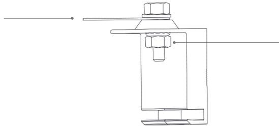
2. Em seguida, aperte o parafuso usando a porca dentada.
