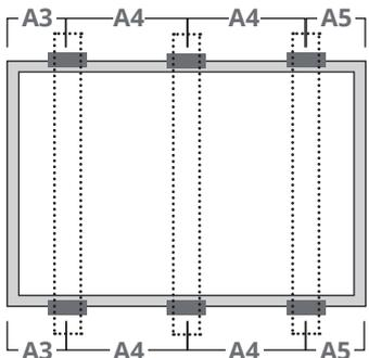
Utilize seis grampos no lado longo. Os trilhos de montagem são perpendiculares à estrutura do lado longo.
