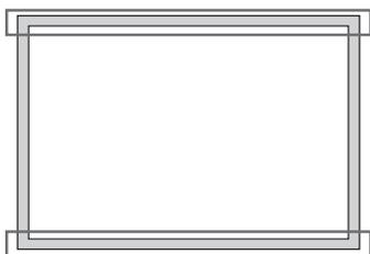
Utilize dois perfis de inserção executando paralelamente ao quadro do lado longo.
