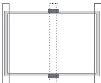
Utilize dois perfis de inserção correndo perpendicularmente ao quadro do lado longo. Uma barra de suporte adicional deve ser colocada abaixo do módulo. Use dois grampos na barra de suporte.
