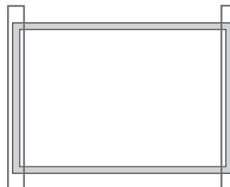
Utilize dois perfis de inserção executando perpendicularmente ao quadro do lado longo.
