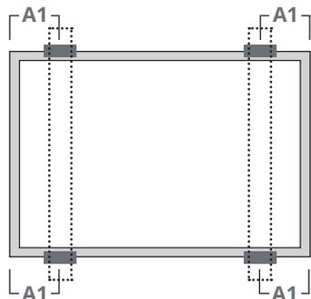
Utilize quatro grampos no lado longo. Os trilhos de montagem são perpendiculares à estrutura do lado longo.
