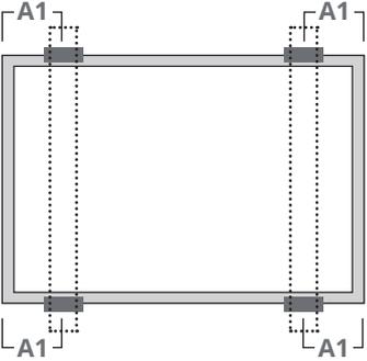
Utilize quatro grampos no lado longo. Os trilhos de montagem são perpendiculares à estrutura do lado longo.
