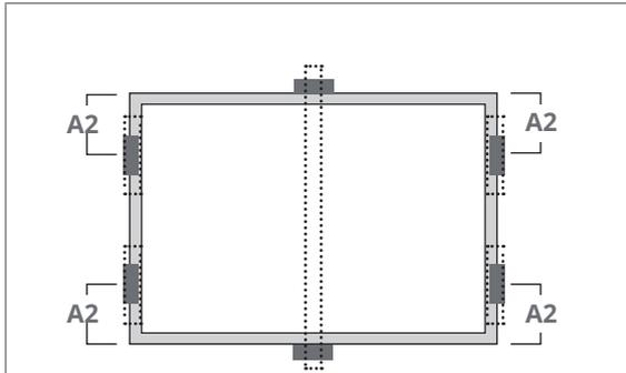
Utilize quatro grampos no lado curto e dois grampos no lado longo. Uma barra de suporte adicional deve ser colocada abaixo do centro do módulo.
