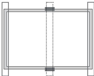
Utilize dois perfis de inserção executando perpendicularmente ao quadro do lado longo. Uma barra de suporte adicional deve ser colocada abaixo do módulo. Utilize dois grampos na barra de suporte.
