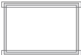
Utilize dois perfis de inserção executando paralelamente ao quadro do lado longo.
