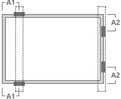
Utilize dois grampos no lado longo e dois grampos no lado curto. Os trilhos de montagem são perpendiculares à estrutura do lado longo.
