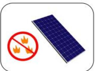
O módulo não deve ser instalado próximo a fogo ou materiais inflamáveis.
