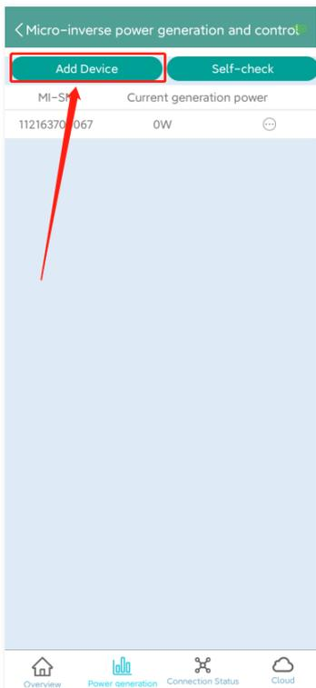
3. É possível adicionar o microinversor através da "Busca automática" ou digitando o ID do microinversor ou escaneando o ID.
