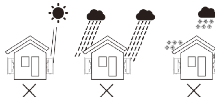
▲ Figura 5.1 b Posição de instalação não adequada
