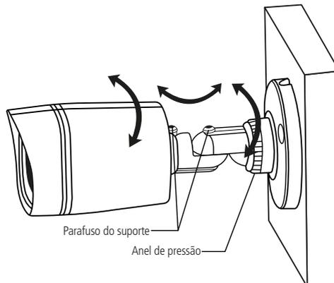
5. Após ajustar a posição da câmera, aperte os parafusos para que o ângulo da imagem se mantenha fixo.
