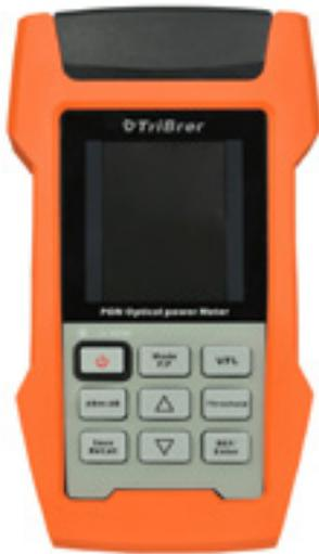
**DESCRIÇÃO:** O medidor de potência NZ-PMOPON PON é projetado para testes de rede PON. Ele pode testar e exibir comprimentos de onda de 1310nm, 1490nm, 1550nm de uma só vez e pode detectar o sinal de estouro de 1310nm.
