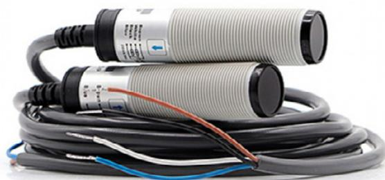
O Sensor Fotoelétrico Nazda NZ-CGY30E-D50NC é um sensor de proximidade fotoelétrico do tipo difuso. Possui uma área de detecção de 30mm<sup>2</sup> e uma distância sensora de 50cm. Esse tipo de sensor é capaz de detectar a presença ou ausência de objetos com base na reflexão da luz emitida pelo próprio sensor.
