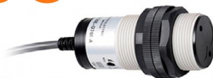
O Sensor Fotoelétrico Nazda NZ-CGY30E-D70PC é um sensor de proximidade fotoelétrico do tipo difuso ajustável. Possui uma área de detecção de 30mm<sup>2</sup> e uma distância sensora de 70cm. Esse tipo de sensor é capaz de detectar a presença ou ausência de objetos com base na reflexão da luz emitida pelo próprio sensor.
