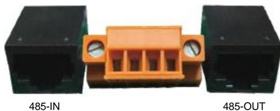
▲ Figura 5.24 Porta RJ45 e placa de terminais
