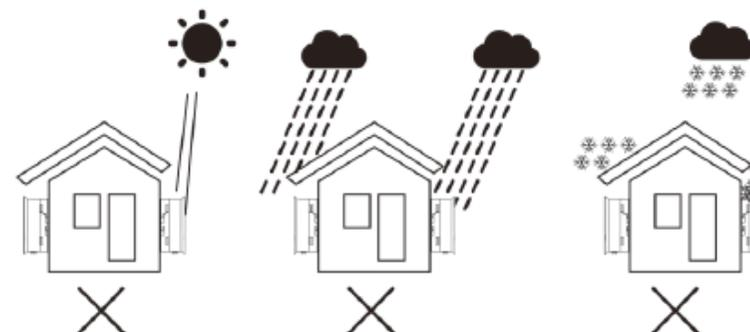
▲ Figura 5.1 b Posição de instalação não adequada
