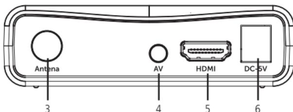
3. **Antena:** entrada para conexão do cabo da antena.
