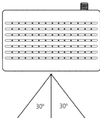
Para utilizar o controle remoto, será preciso apontá-lo para a parte dianteira do conversor. Seu alcance pode chegar a uma distância de até 5 metros. O raio de captura do sinal do controle é de aproximadamente 60°.
