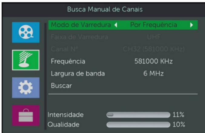
**Obs.:** para ter sucesso na captação e memorização do canal, é preciso que o sinal esteja com alto nível de intensidade e qualidade. Verifique o canal e a frequência que devem ser configurados com a emissora para que possa ser realizada a busca manual.
