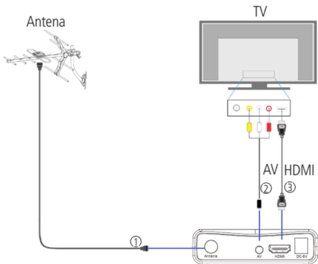
1. **Antena:** conecte a antena UHF interna ou externa.
