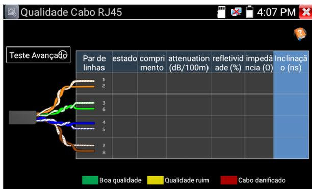
Conecte o cabo RJ45 na porta LAN do TESTER 3000 MT, inicie o teste clicando sobre o botão *Teste Avançado*. Após, as informações a seguir serão apresentadas.
