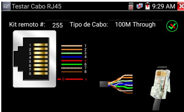
» Se todos os fios estiverem rompidos ou não houver conexão entre o TESTER 3000 e o dispositivo No.255, todos serão representados pela cor vermelha e o símbolo
