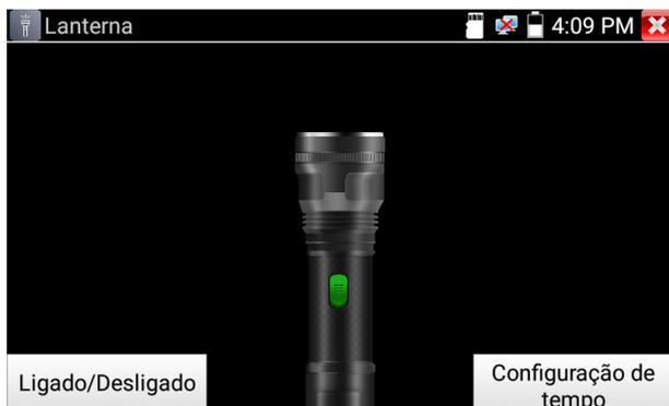
Pressione o botão **Ligado/Desligado** para ligar ou desligar a lanterna do TESTER 3000. Também é possível configurar o tempo restante em que a lanterna ficará acesa, com tempo limite de 60 minutos. Toda vez que sair da configuração de tempo da lanterna, a mesma voltará a configuração de 30 minutos.
