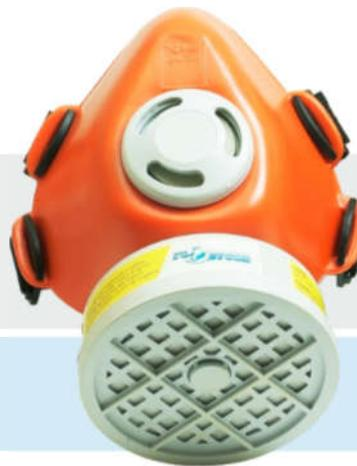
**DESCRIÇÃO DO PRODUTO** - Respirador com manutenção destinado à purificação do ar, composto por uma peça um quarto facial em termoplástico atóxico, um conector para fixação dos elementos filtrantes, uma válvula de exalação, uma válvula de inalação e quatro pontos de fixação com tirantes elásticos com ajustes através de passadores. Este respirador pode ser utilizado somente com filtros químicos.
