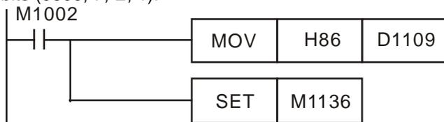
**Example 4: RTU mode setting of COM1、COM2、COM3**
