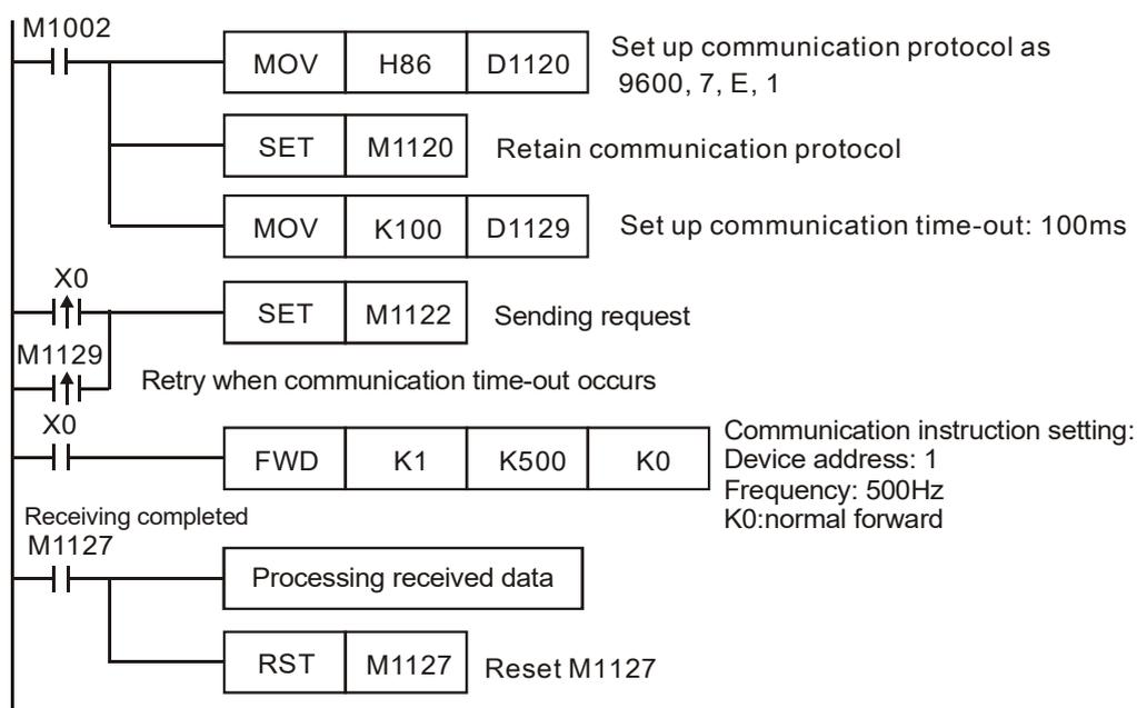
PLC ⇒ VFD, PLC sends: **“:01 10 2000 0002 04 0012 01F4 C2 ”**
