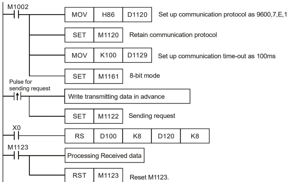
PLC ⇒ VFD-B, PLC sends: **01 06 2000 0012 02 07**
