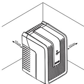
1. Instale o estabilizador em um ambiente seco com temperatura máxima de 40°C. Não instale o estabilizador em locais sob exposição a temperaturas extremas, pó excessivo, umidade, vibração, gases inflamáveis e atmosfera corrosiva ou explosiva.
