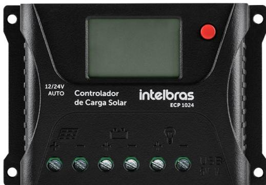
O controlador de carga é o dispositivo utilizado para gerenciar e controlar o processo de carga e descarga do banco de baterias. Instalado entre o módulo fotovoltaico e a bateria, protege, otimiza e prolonga a vida útil da mesma. Possui saída para alimentação direta de cargas CC e saída USB 5 Vcc.
