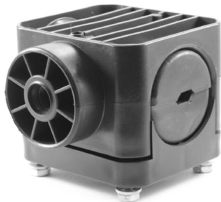
**DESCRIÇÃO:** Suporte dielétrico cônico atende fibra óptica de 6 a 16mm com 4 parafusos. A fabricação da parte externa do produto é feita em material dielétrico de alta resistência. A parte interna é feita elastômero dielétrico, sendo que, esse tipo de material não danifica a estrutura protetora do cabo de fibra óptica.
