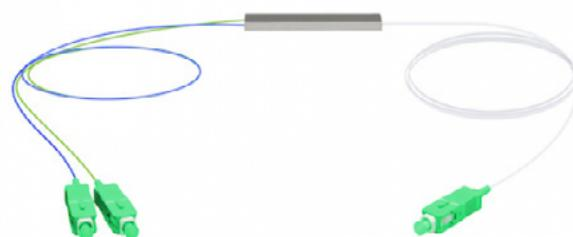
O Splitter Óptico Balanceado, 1x4, da Nazda, possui conectores SC/APC. É ideal para realizar a divisão de sinal de luz emitido pela OLT. É semelhante a um switch de internet, contudo, não realiza a divisão de dados e sim do sinal óptico recebido em uma rede PON.
