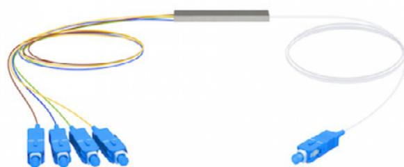
O Splitter Óptico Balanceado, 1x4, da Nazda, possui conectores SC/UPC. É ideal para realizar a divisão de sinal de luz emitido pela OLT. É semelhante a um switch de internet, contudo, não realiza a divisão de dados e sim do sinal óptico recebido em uma rede PON.
