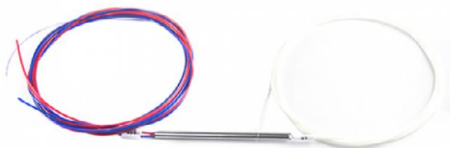
O Splitter Óptico Desbalanceado, da Nazda, é utilizado para divisão do sinal óptico proveniente de uma fibra para duas (1x2). Possui a característica de dividir este sinal em proporções diferentes para duas fibras, sendo essa divisão em uma proporção de 35% do sinal óptico para uma fibra e 65% para a outra.
