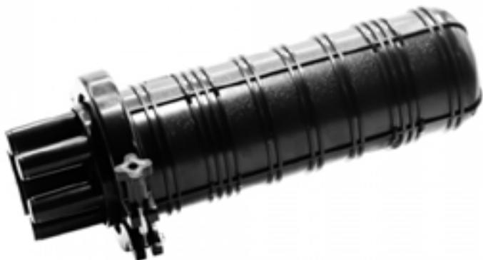
Descrição: A Caixa de Emenda de Cabos Ópticos ou CEO, da Nazda, pode alocar até 144 Fibras Ópticas. Está equipada com 2 bandejas que suportam até 24 fibras cada uma. Extremamente robusta, esta CEO é fabricada em plástico ABS, com antienvelhecimento de alta qualidade e selado com silicone.
