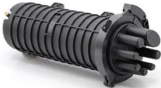
A caixa de emenda é destinada à provedores e operadoras de internet, utilizada em projetos FTTH para proteger emendas e fazer a distribuição de cabos ópticos em redes aéreas ou subterrâneas. Projetada para uso externo, possui isolamento e proteção UV, além de um sistema de travas que garante durabilidade, segurança e proteção para as emendas. Permite um total de até 96 emendas (dispostas em até 04 bandejas com 24 fibras cada).
