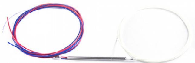
O Splitter Óptico Desbalanceado, sem conector, da Nazda, é utilizado para divisão do sinal óptico proveniente de uma fibra para duas (1x2). Possui a característica de dividir este sinal em proporções diferentes para as duas fibras, sendo essa divisão em uma proporção de 25% do sinal óptico para uma fibra e 75% para outra.
