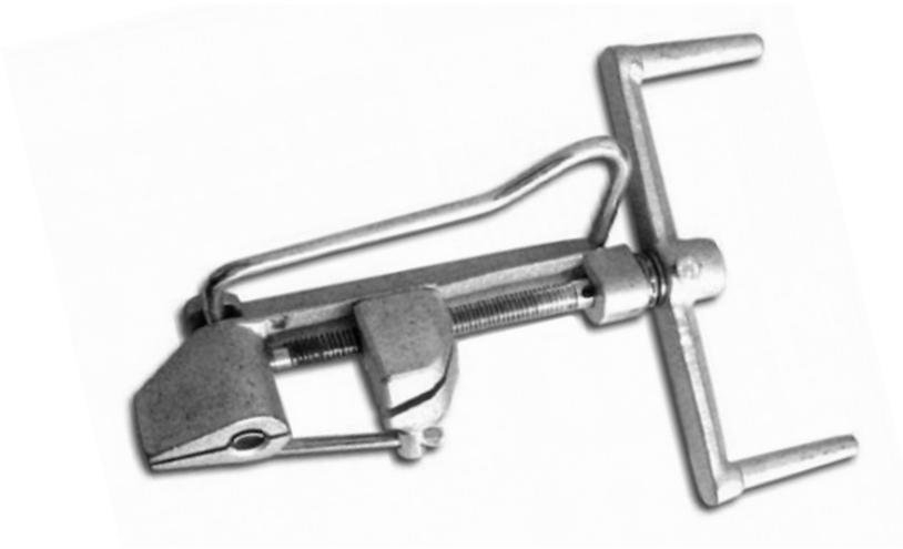
A máquina para cintar poste é ideal para confecção de abraçadeiras de alta pressão em fitas de aço, efetuando a fixação, aperto e o corte da fita durante os serviços de arquear ou cintar postes com o uso de fecho de aço inox dentado.
