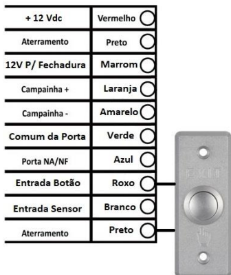
Figura 3-3 Diagrama de fiação do botão da porta
