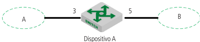
Diagrama de rede para VLAN baseada em protocolo
