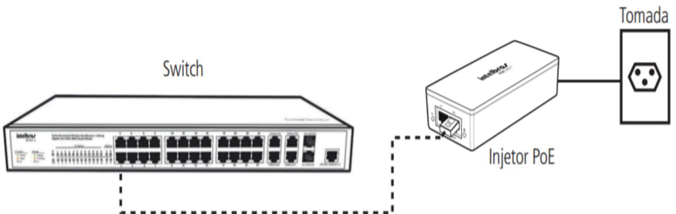
3. Conecte o injetor PoE 200 AT ao dispositivo PD (telefones IP, ponto de acesso de redes sem fio, câmeras de rede ou outros dispositivos compatíveis com os padrões 802.3af e 802.3at) utilizando a porta PoE do injetor. O cabo de rede utilizado nesta conexão deverá ser Cat.5 ou superior e de no máximo 100 metros.
