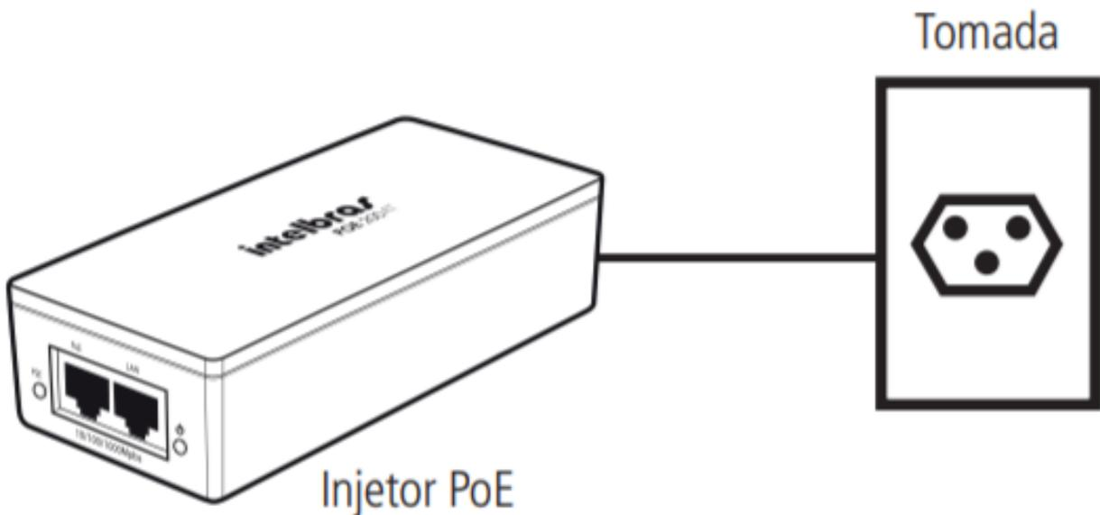
2. Conecte o injetor PoE 200 AT ao switch de sua rede utilizando a porta LAN do injetor. O cabo de rede utilizado nesta conexão deverá ser Cat.5 ou superior e de no máximo 100 metros.
