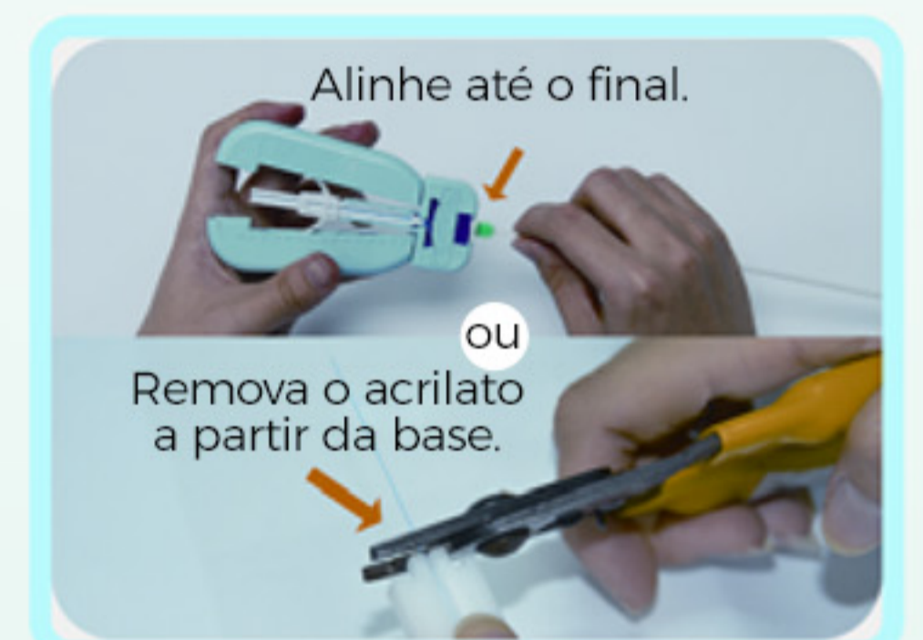
2.4 - Remova o acrilato que envolve o fio da fibra
