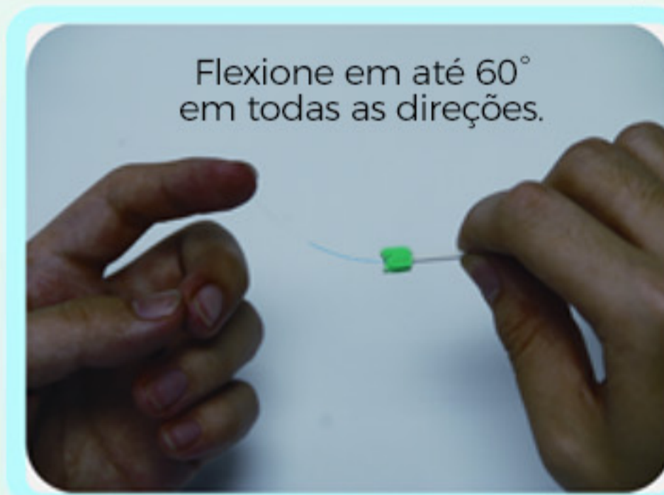
2.5 - Confirme a resistência da base da fibra.
