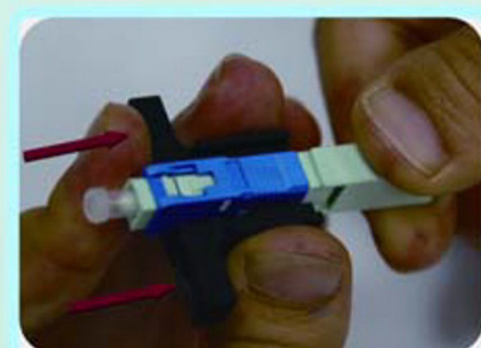
2.14 - Destrave a fibra movendo na direção indicada.
