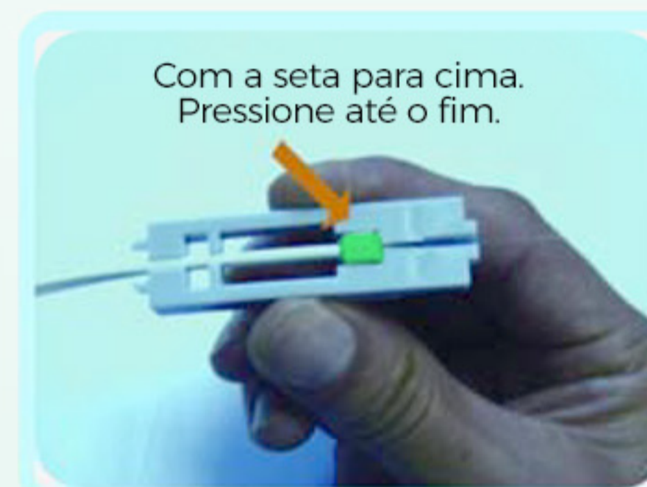
2.3 - Posicione a fibra no gabarito, para a Clivagem.
