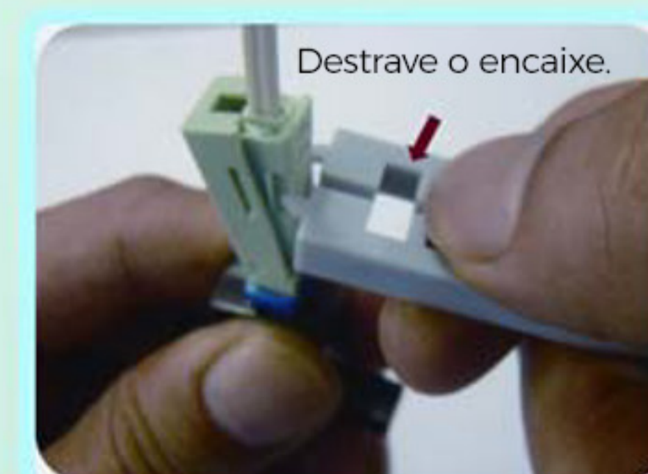
2.15 - Utilize o gabarito para abrir a capa do conector.
