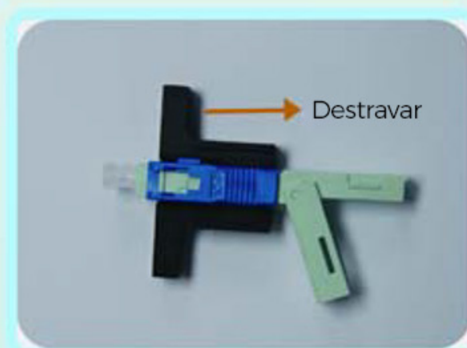
2.9 - Libere a trava do conector, movendo a chave auxiliar na direção indicada
